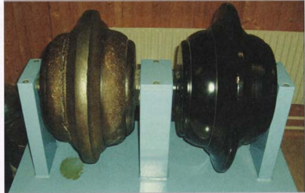
Bild 6. Einer der Fräser eines Grippers aus hoch verschleißbeständigem Stahlguss, rechts im neuen Zustand und links im abgearbeiteten Zustand, dessen Haltbarkeit stark von der Gesteinhärte abhängig ist und die im Vortrieb immer wieder ausgewechselt werden müssen, wenn sie verschlissen sind.
